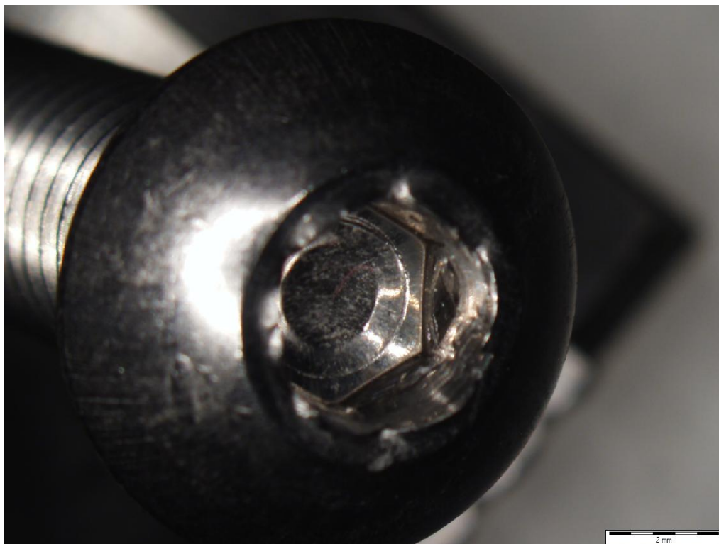
Bild 2: Schaden auf dem Kopf der Schraube auf Drehmoment > 40 Nm
